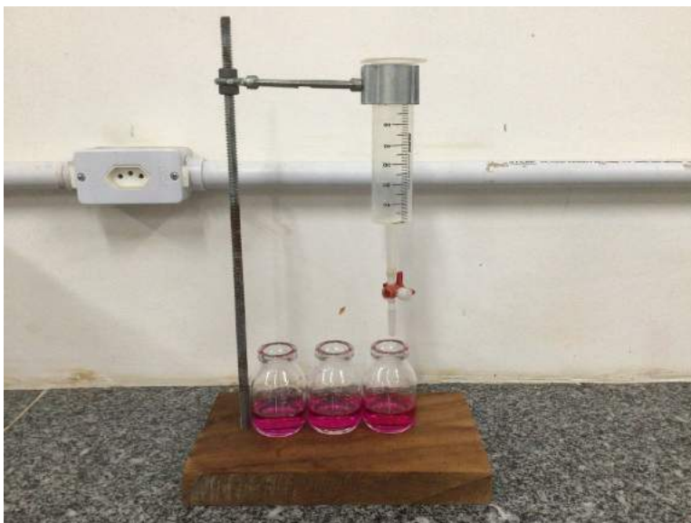
Figura 4: Titulação teste com o kit alternativo.
