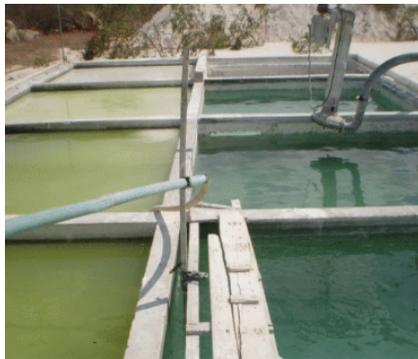
Figura 09: Efluente do beneficiamento com tratamento em circuito fechado.
