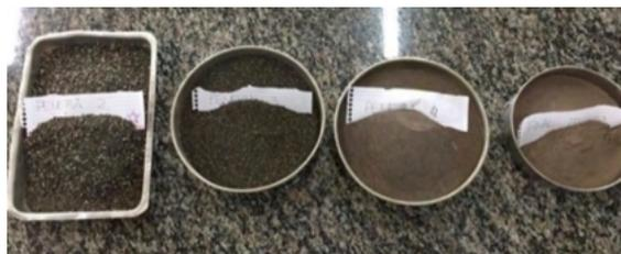
Figura 1 – Cinza após moída e peneirada.
