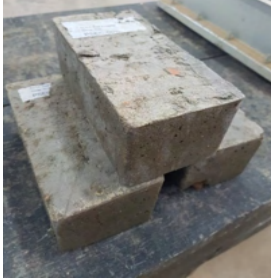
Figura 2 – Ângulos, arestas e rebarbas dos blocos
