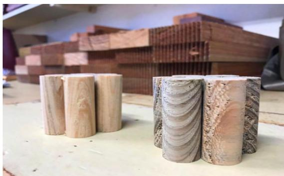
Figura 4 - Corpos-de-prova extraídos da madeira de doação *Pinus taeda*.
