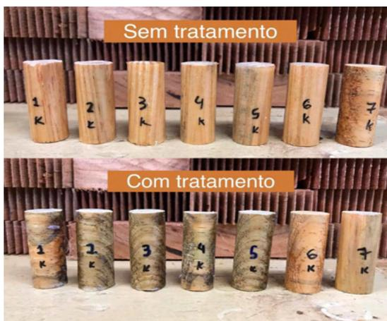
Figura 17 - Corpos-de-prova Pinus taeda extraídos e numerados.
