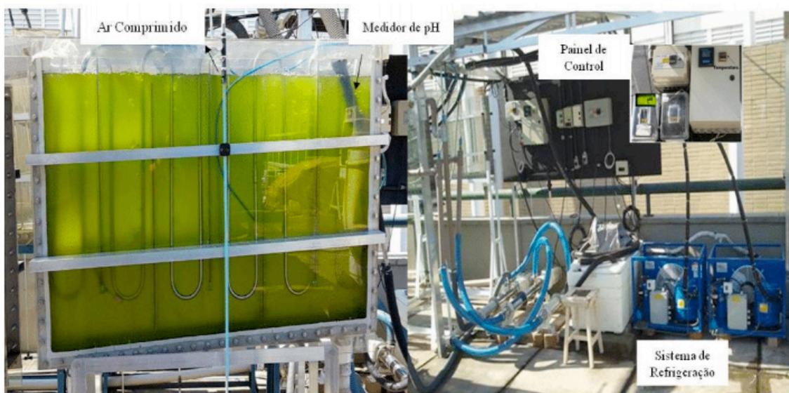
**Figura 4-** Fotobiorreator transparente tipo Janela – FT, com iluminação direta de luz solar.
