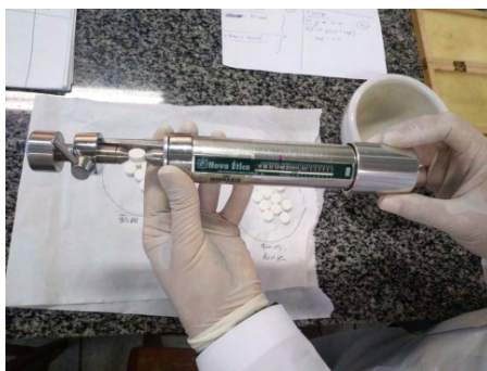
Figura 3 – Imagem de execução da determinação de dureza de comprimidos com durômetro de mola
