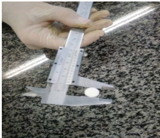
Figura 2- Paquímetro usado nas medições de altura
