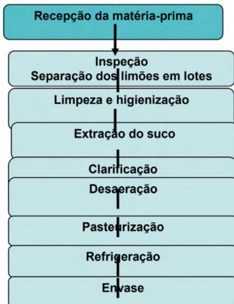
Figura 10. Fluxograma do processamento de suco de limão pasteurizado.
