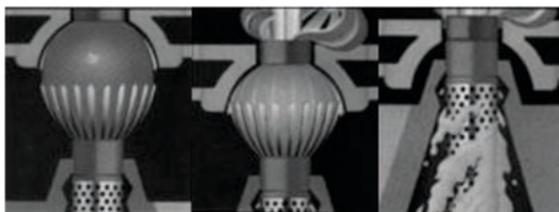
Figura 4. Acomodação e fixação dos limões para a extração no *FMC Citrus Juice*.
