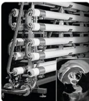
Figura 14. *Flash cooler* – detalhe do sistema de aquecimento e resfriamento.
