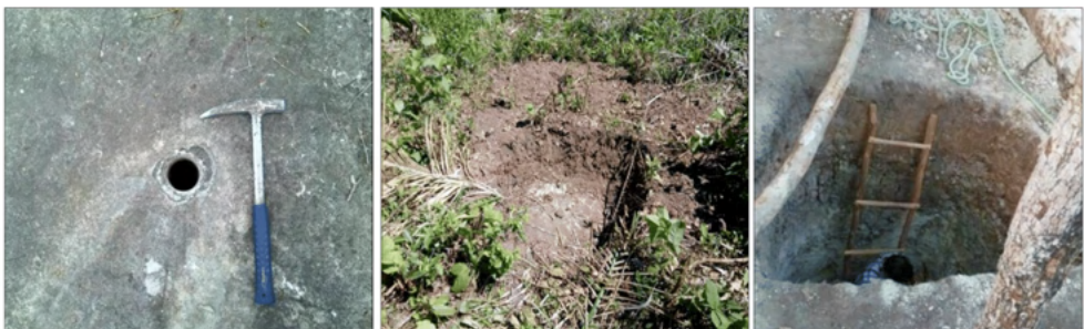
Figura 7 - Furo de sonda realizados em afloramento do minério, trincheira e poço escavados para descrição do material de recobrimento, respectivamente
