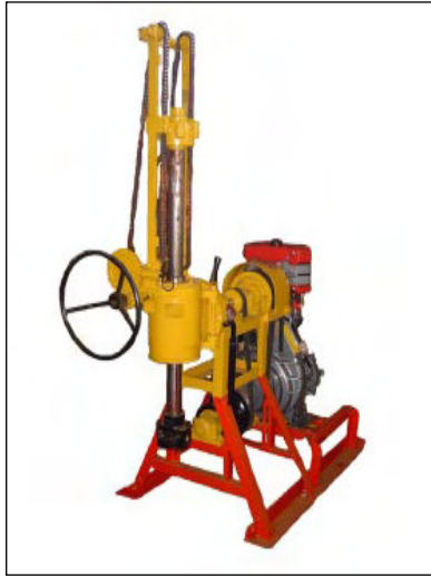
Figura 5 – Equipamento utilizado para execução das sondagens
