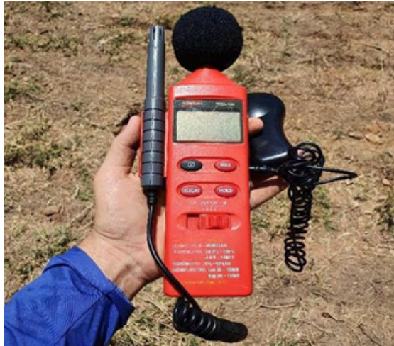
Figura 8: Medidor digital portátil 4 em 1.
