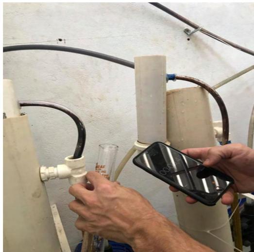
Figura 18 – Aferição da vazão pelo método volumétrico.
