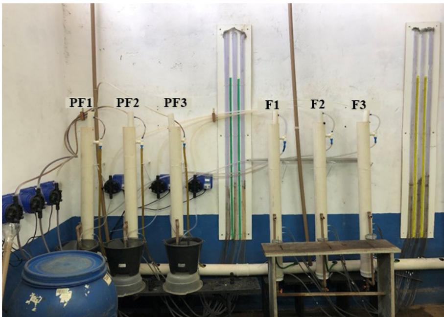
Figura 14 – Conjunto de pilotos de pré-filtração e filtração construídos no LABTAG.
