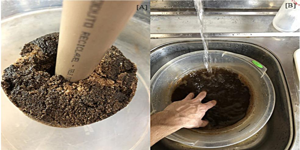
Figura 22 – Demonstração da raspagem e limpeza do meio filtrante.
