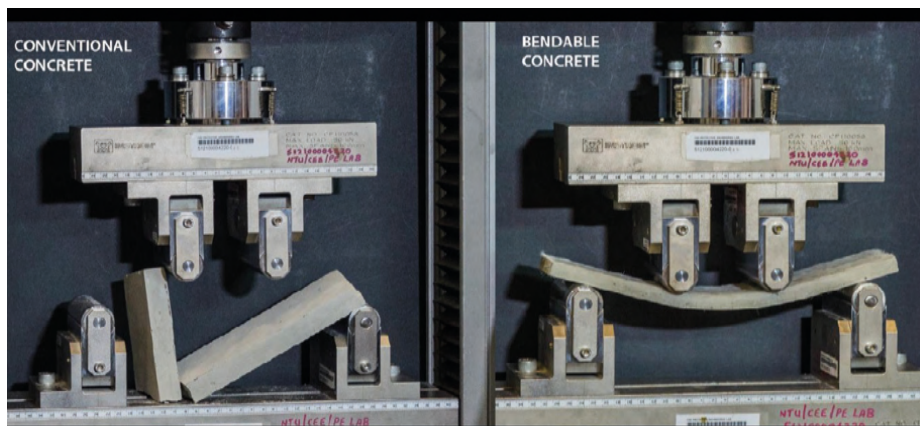
Figura 7: Comparação entre o concreto convencional e o ConFlexPave.
