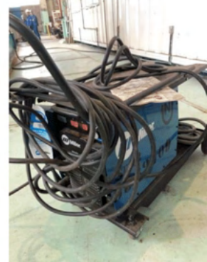
Figura 7. Máquinas TIG com fonte inversora pulsada DC e Máquina arco elétrico SMAW.
