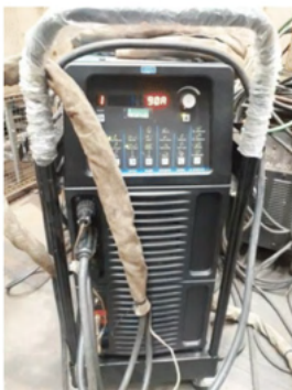
Figura 7. Máquinas TIG com fonte inversora pulsada DC e Máquina arco elétrico SMAW.
