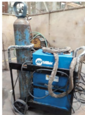
Figura 7. Máquinas TIG com fonte inversora pulsada DC e Máquina arco elétrico SMAW.
