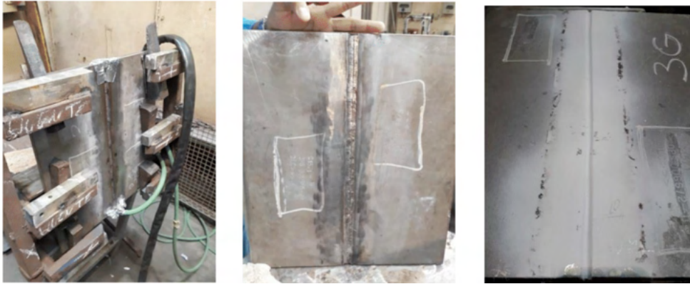
Figura 8. Soldagem das amostras utilizadas para a retirada dos corpos de prova do QPS
