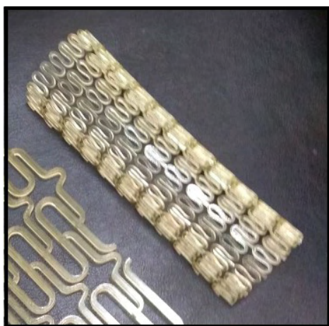
Figura 4: Desenho de uma das estruturas escolhidas de stent impresso em 3D.
