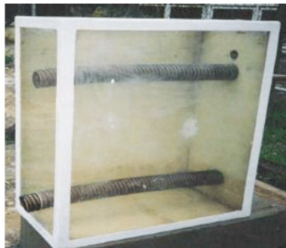
Figura 3: Foto de uma das caixas de acrílico com tubulação de dreno interna.
