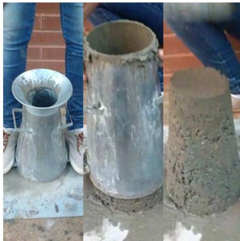
Figura 2 - Slump Test.
