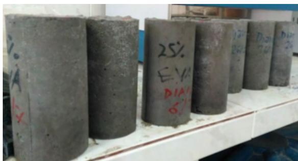
Figura 3 - Corpos de prova desmoldados e identificados.
