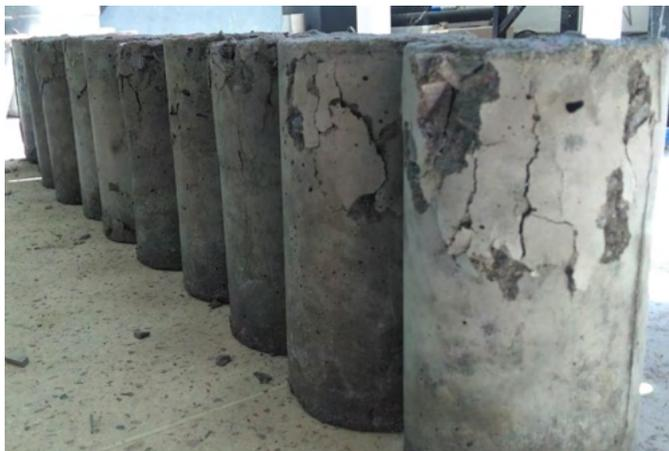
Figura 5 – Amostras após ensaio de Compressão.
