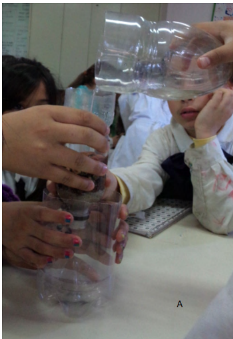
Figura 3 – A) Preparación de filtro con algodón, arena y pedregullo lavado, B) Agua filtrada.
