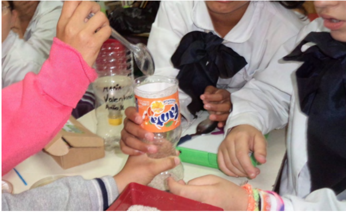
Figura 2 – Preparación de filtro con algodón, arena y pedregullo lavado
