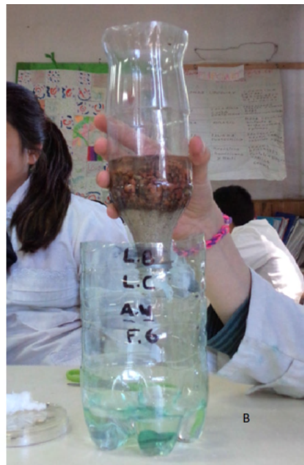
Figura 3 – A) Preparación de filtro con algodón, arena y pedregullo lavado, B) Agua filtrada.
