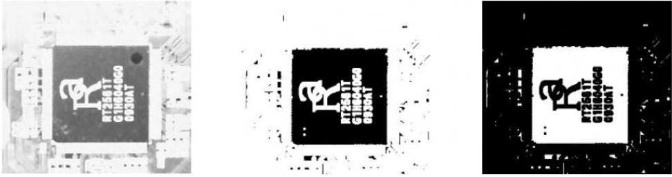
Figura 5. Imagen dilatada, binaria e invertida. Elaboración propia.
