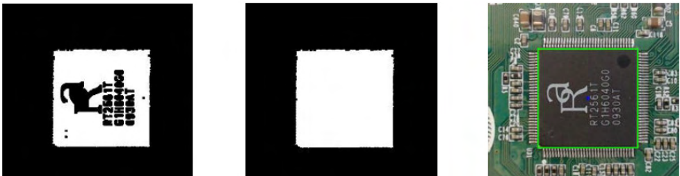
Figura 6. Imagen filtrada, rellena y con C. I. identificado. Elaboración propia.
