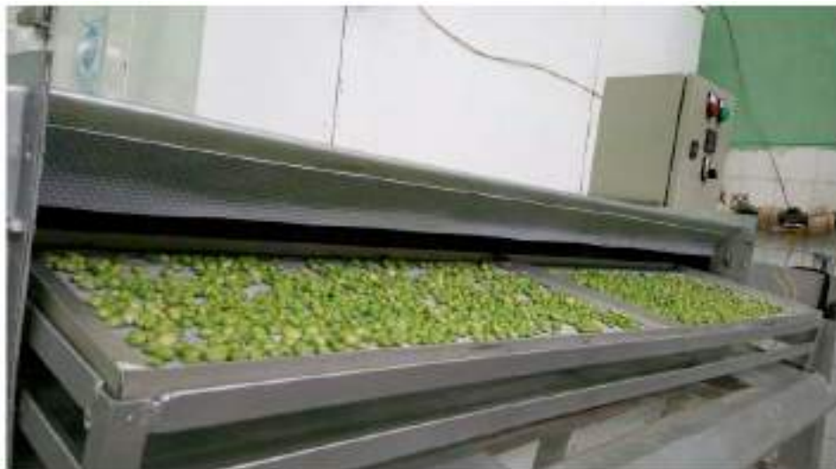
FIGURA 3 Secador tipo túnel con bandejas para productos alimenticios, con temperatura, tiempo y velocidad de aire controlados
