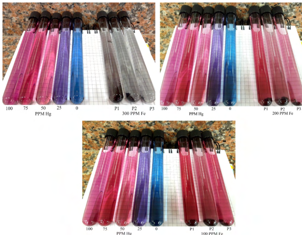
Figura 10. Escalas complexométricas de 300, 200 y 100 PPM de Fe
