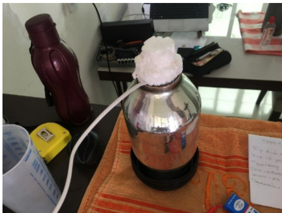
Figura 10 – Paredes espelhadas com vácuo com o TDBC em coleta de dados.
