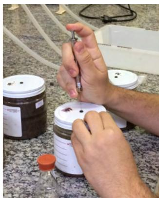
Figura 4. Amostragem dos gases com seringa cromatográfica.
