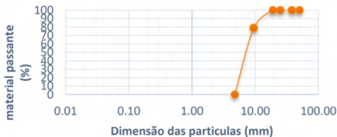
Gráfico 6. Curva granulométrica do cascalho comercializado por cascalho 12mm (granítico) no município de Governador Dix-Sept Rosado - RN.
