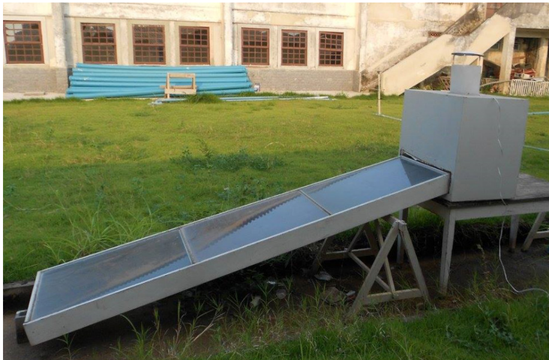
Figura 1 – Secador híbrido solar-elétrico
