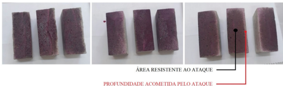
Figura 7 – Efeitos do ataque por sulfatos sobre o concreto (DE LIMA e SILVA et al. , 2018).
