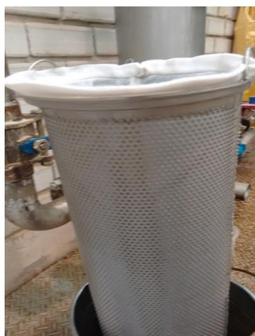
Figura 10: Encaixe do elemento filtrante com o cesto
