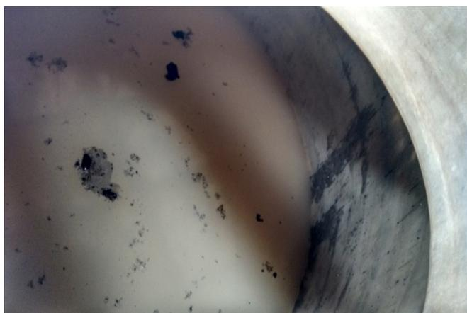
Figura 8: Resíduo sobrenadante no tanque de armazenamento
