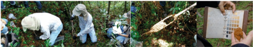
Figura 3. Extração de amostras de solos e classificação em campo (Foto: Márcia Toffani Simão Soares).
