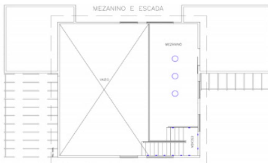
**Figura 9:** Planta esquemática dos equipamentos de iluminação artificial do EV mezanino
