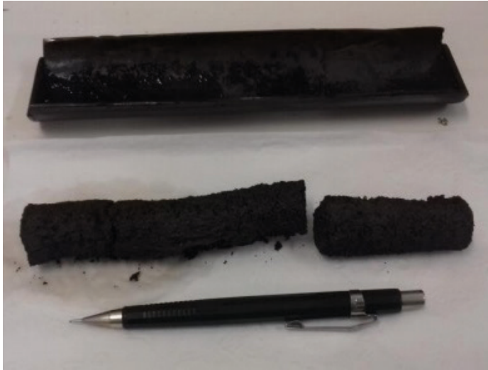
Figura 1: Carvão ativado a partir da pirólise da casca de arroz
