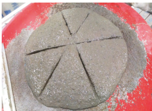
Figura 2 - Ensaio de Índice de Consistência após os golpes (NBR 7181)
