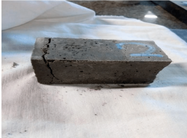
Figura 5 - Corpo de prova após rompimento do ensaio de compressão axial
