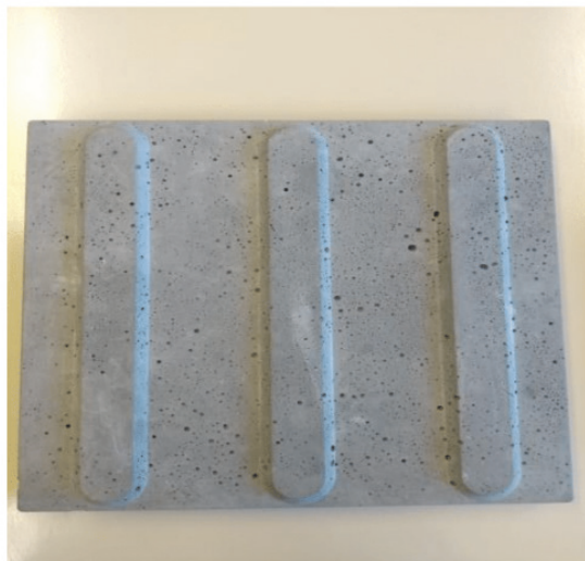
Figura 3- Amostra de lajota após cura de 28 dias em solução de cal.
