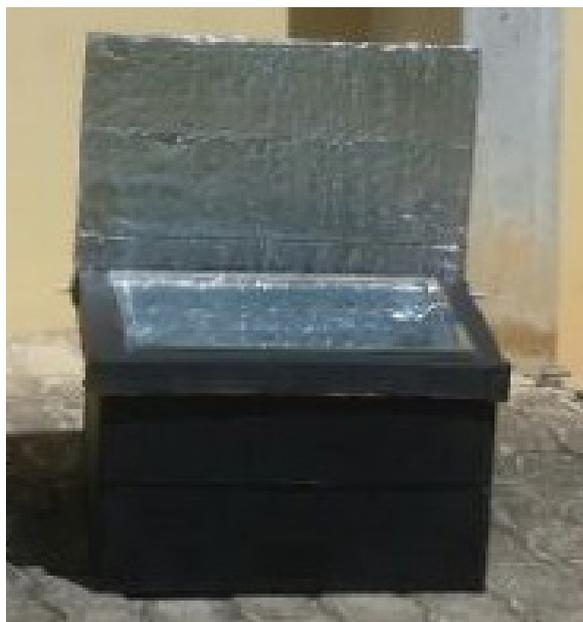
**Figura 1:** Detalhe do fogão solar tipo caixa
