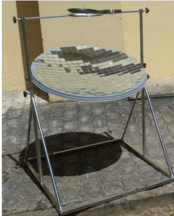
**Figura 2:** Detalhe do fogão solar com concentrador parabólico
