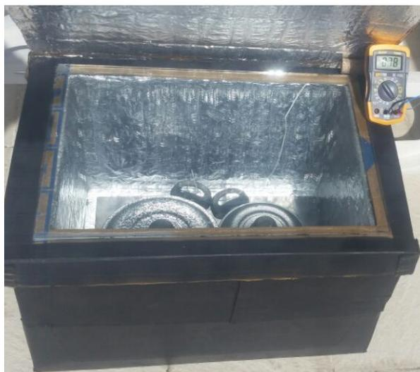
Figura 8: Fogão solar para cozimento de alimentos.
