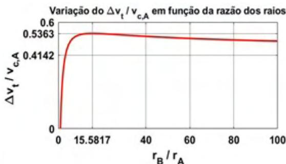
Figura 3 - A razão do pela velocidade circular da órbita interna em função de  $\alpha$ .
