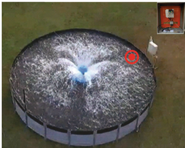
FIGURA 1 – Projeção do tanque, aerador e inversor de frequência.
