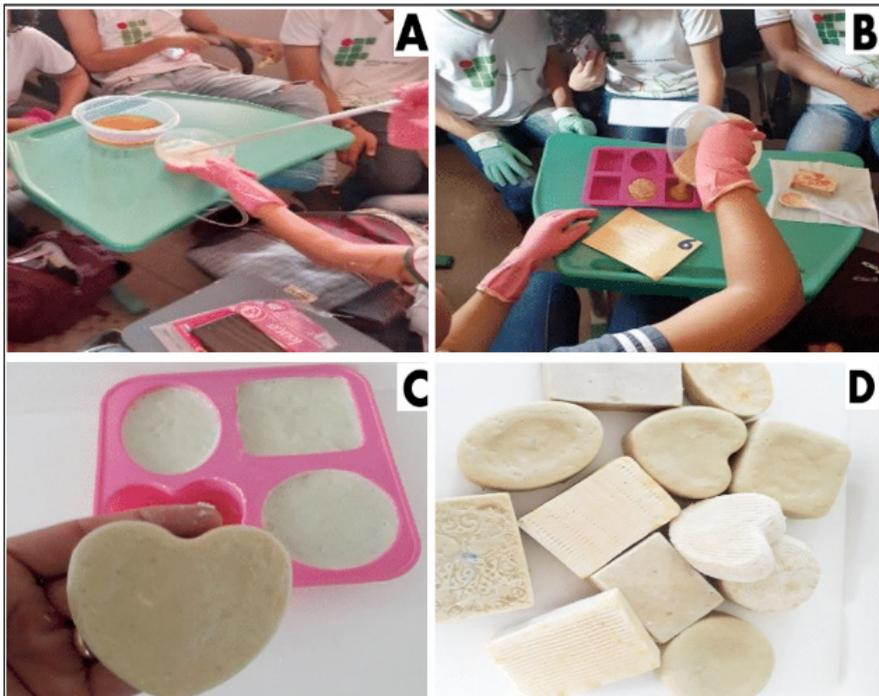
Figura 01: A fabricação de sabão a partir do óleo de cozinha usado. A) Mistura dos ingredientes: óleo, soda cáustica, água, detergente, corante e sabão em pó. B) Colocando o sabão na forma de silicone. C) Processo de clareamento e secagem do sabão. D) Sabão pronto para o uso após quinze dias de secagem.
