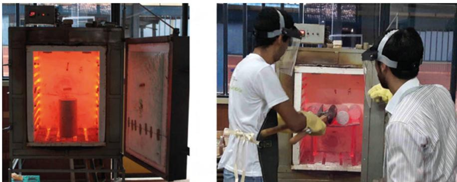
Figura 6 – Forno tipo mufla utilizado
