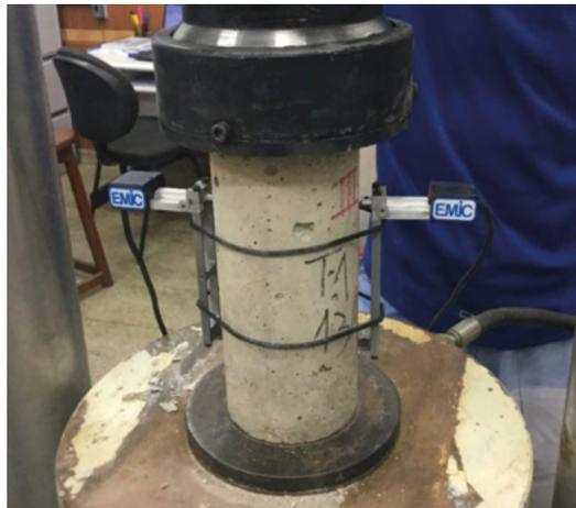
Figura 5 – Extensômetros eletrônicos empregados na determinação do diagrama tensão-deformação
