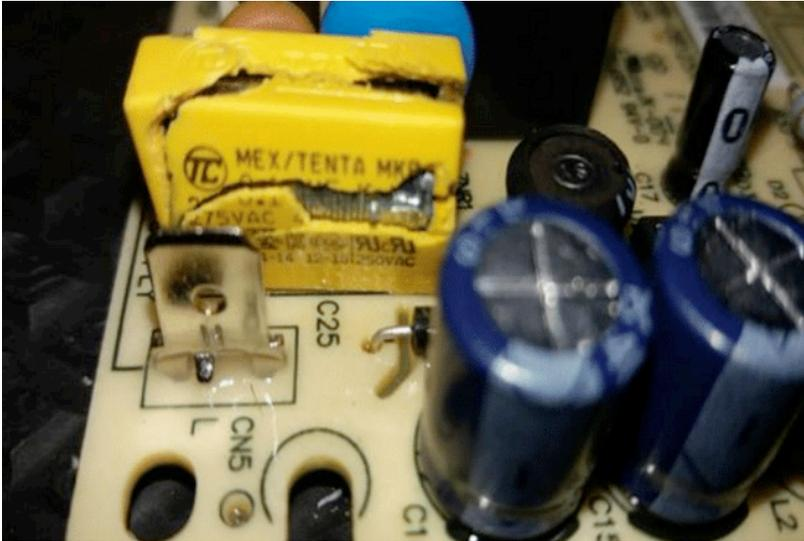
Fig. 5. Fotografia do componente que falhou na placa de potência do refrigerador após surto elétrico.
