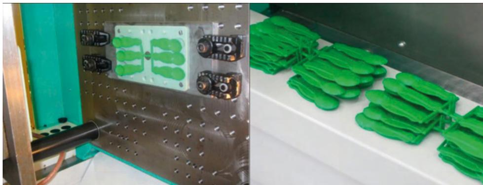
Figura 3- Moldes gerados na impressora 3 D
