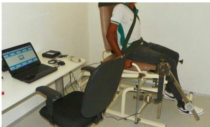
Figura 06 – Unidade de aquisição de dados (N2000 – Cefise Biotecnologia).
