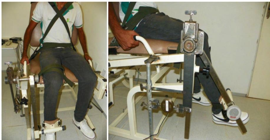
Figura 05 – Ergômetro projetado para avaliação da força muscular.
