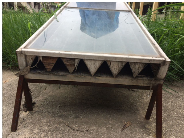
Figura 3. Cantoneiras sanfonadas em triângulo do coletor solar.
