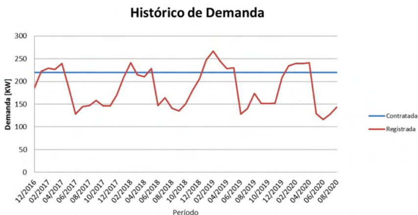
Figura 2- Demanda registrada e contratada de energia elétrica no período de janeiro de 2017 à agosto de 2020 do HE/UFPEL/EBSERH.
