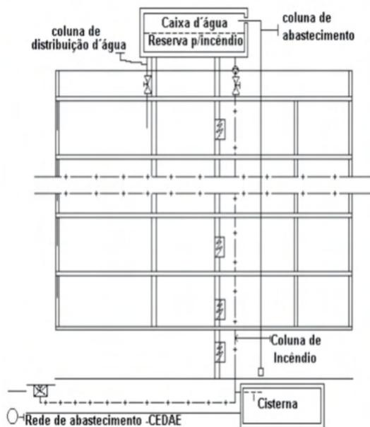
Figura 1 – Sistema de Hidráulico de Incêndio
