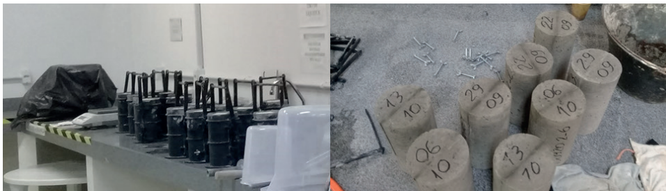
Figura 5. Na imagem a esquerda, os corpos de prova (CPs) acondicionados por 24 horas em local nivelado. A direita, os CPs já desmoldados e identificados, prontos para serem colocados no tanque com água.
