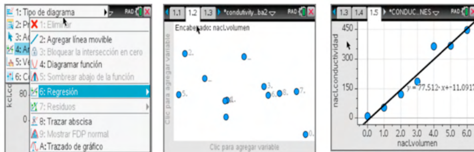
Figura 6. Secuencia de ajuste a una regresión lineal y un diagrama de dispersión para la conductividad del NaCl.
