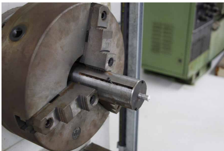
Figura 9 - Dispositivo de fricção controlada acoplada a placa de um torno universal.
