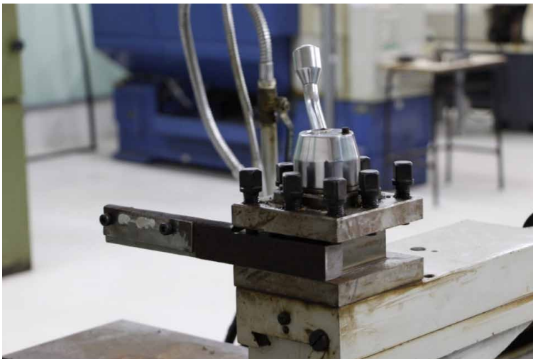
Figura 8 - Dispositivo de fixação rápida para placa substrato.
