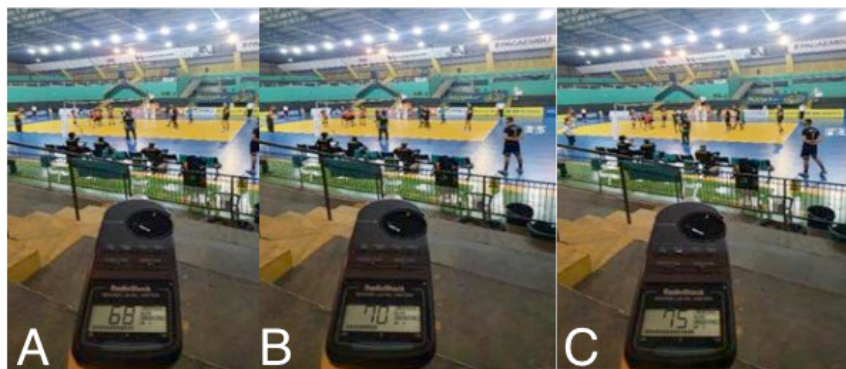
Fig. 5. Fotos de medidor de pressão sonora, indicando as intensidades de 68 dB (A), 70 dB (B) e 75 dB (C) durante jogo sem torcida.
