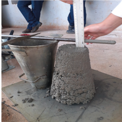
Figura 9: Concreto insaturado com abatimento de 2 cm
