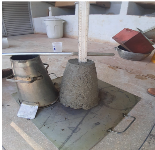
Figura 10: Concreto saturado com abatimento de 4,25 cm
