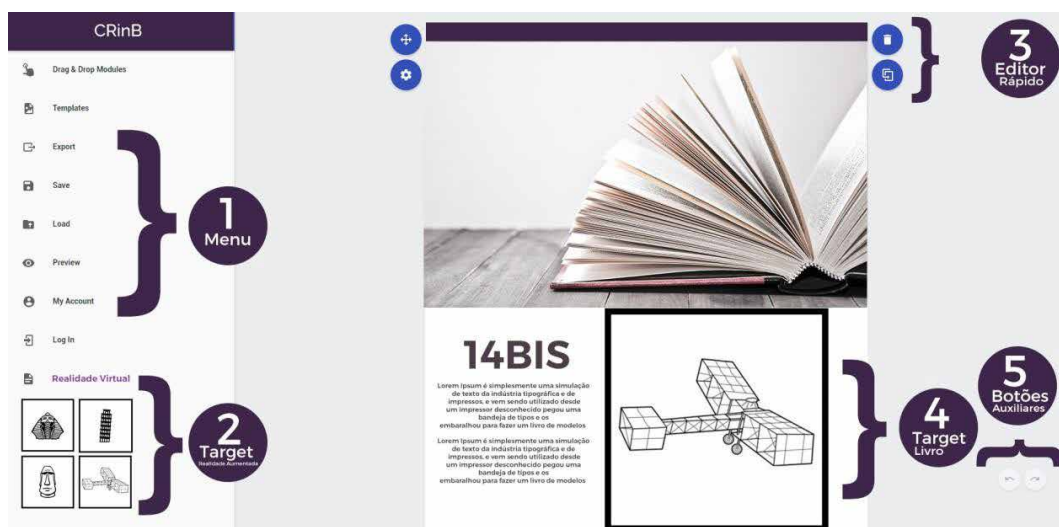
FIGURA 1. Protótipo de Ferramenta; (1)Menu para edição do Livro com Objetos prontos para facilitar o usuário; (2)Biblioteca de target de realidade aumenta pronta para o usuário arrastar para dentro do livro; (3) Botões com edição rápida para o usuário deletar ou editar as imagens, textos, gráficos etc; (4) Target posicionado no livro trazendo um diferencial no conteúdo apresentado; (5) Botões Auxiliares para ir para outra página do livro que está sendo criado.
