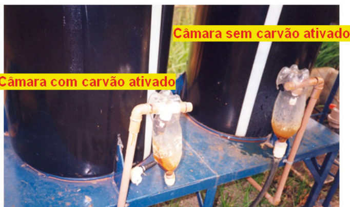
Figura 6: Detalhe do conjunto de filtros lentos.
