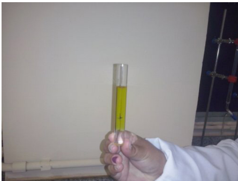
Figura 7: Reação química indicador de solução do repolho roxo com a das caustica.
