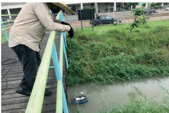
**Figura 03 –** Utilização do perfilador hidroacústico.
